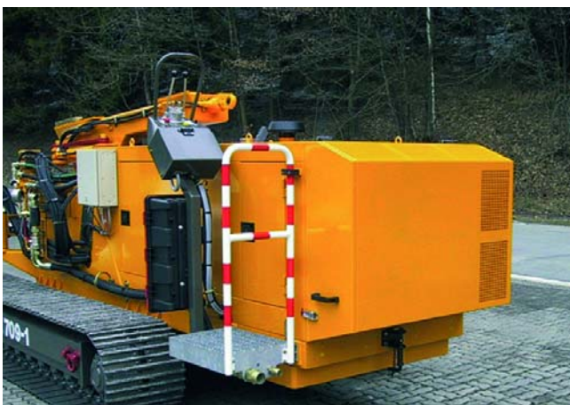
Fahrerstand mit verbesserter Schallschutzhaube drivers stand with sound revised proof cover
