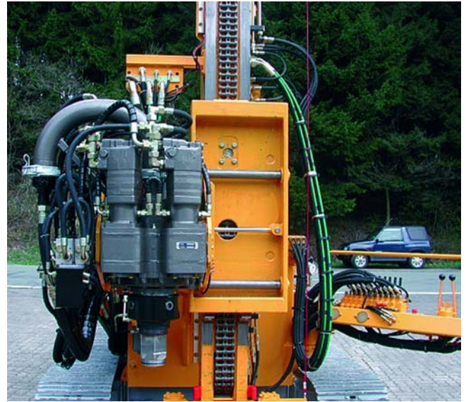
Kraftdrehkopf Typ KH 43 mit 4" Betonierkopf und Schwanenhals auf hydr. seitlich verschiebbarem Schlitten rotary head type KH 43 with 4" concrete injection head and swan neck on hydr. shiftable slide
