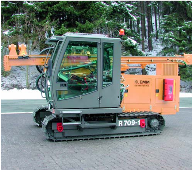
KLEMM Bohrgerät Typ KR 709-1 mit Kabine KLEMM drill rig type KR 709-1 with cabin
