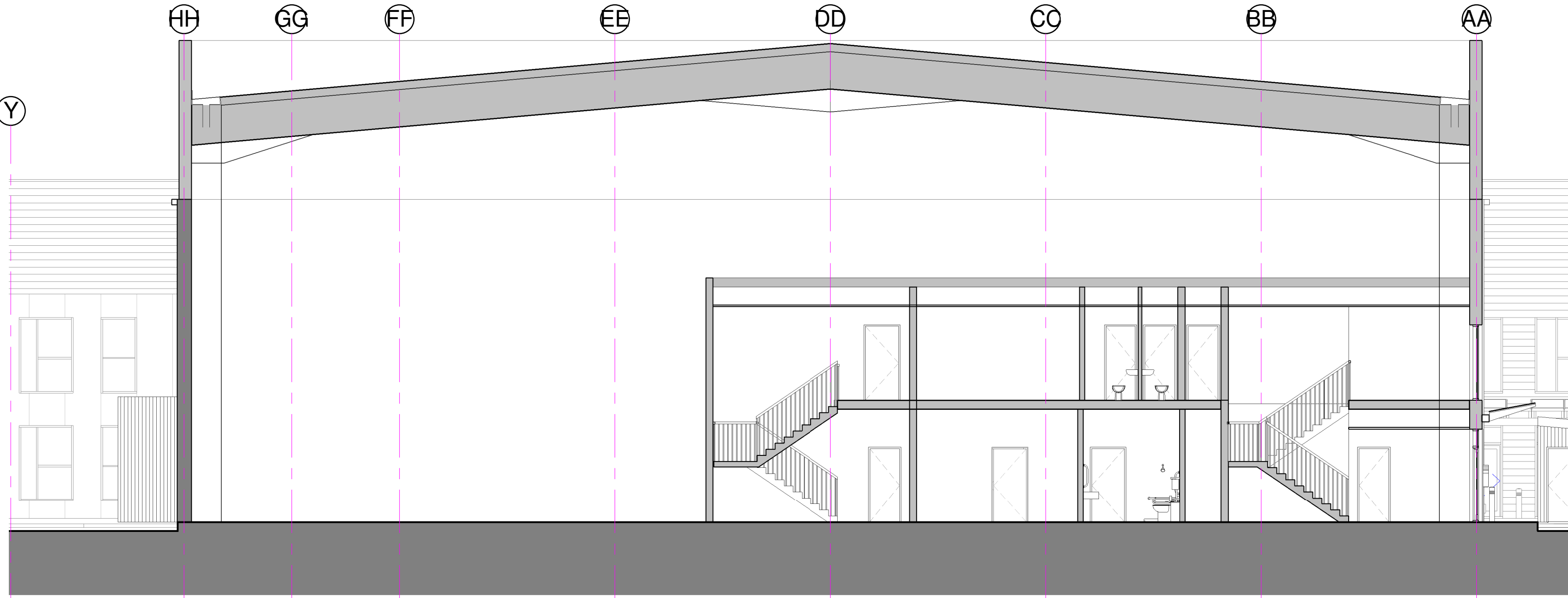
Unit 12 Section - Staircore 1 : 100
