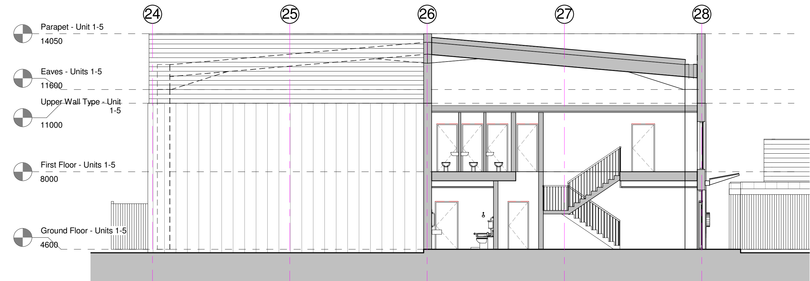
Unit 05 Section - Staircore 1 : 100
