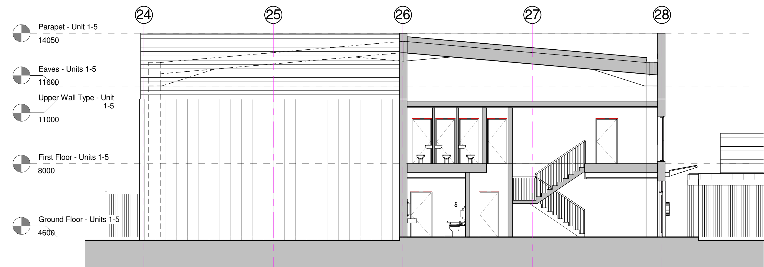
Unit 05 Section - Staircore 1 : 100
