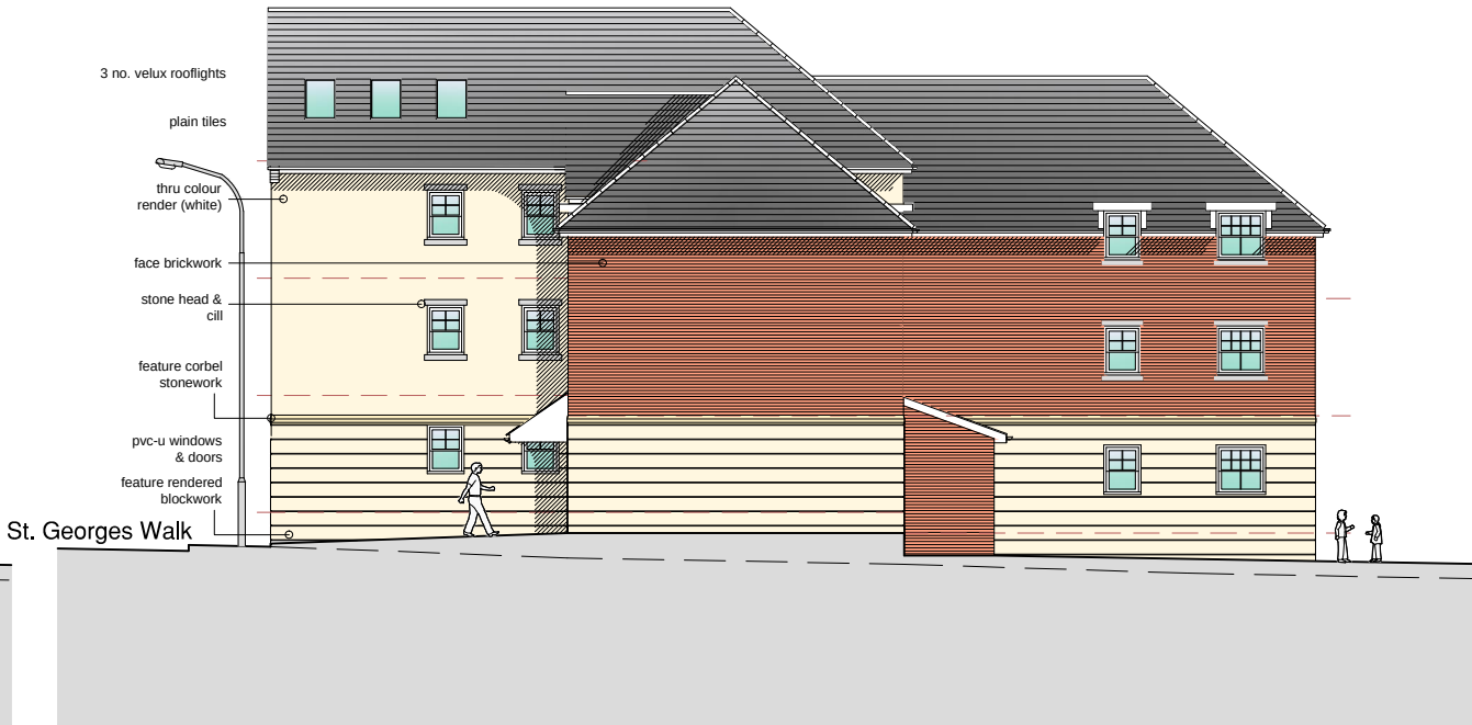
West Elevation (A1 1:100 A3 1:200)
